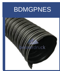
MANGUEIRA DE AR REFORÇADA ESPIRAL NEOPRENE PRETA (25 até 80mm) Temperatura de trabalho: -35°C a +135°C (Picos instantâneos a +150°C)
